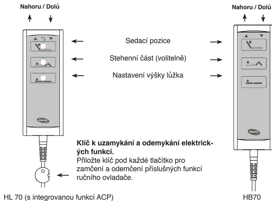
Lůžka mohou být vybavena ručním ovladačem. Tímto ovladačem se ovládá náklon roštu matrace. Ovladač je možno objednat u společnosti *Invacare*®. Viz část „Objednací čísla pro příslušenství“.
