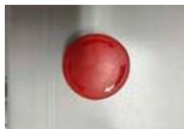
Uvolněte nouzové zastavení otočením ve směru hodinových ručiček
